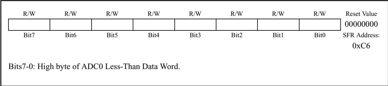
**Figure 5.15. ADC0LTL: ADC0 Less-Than Data Low Byte Register**
