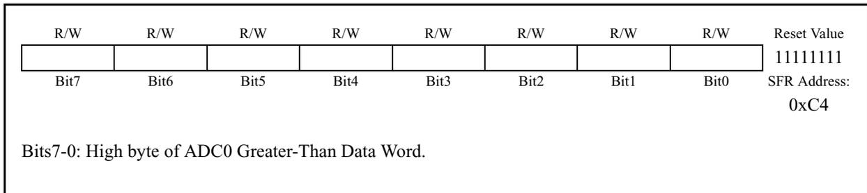
**Figure 5.13. ADC0GTL: ADC0 Greater-Than Data Low Byte Register**
