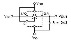
$$R_{\mbox{ON}} = 10 \times \ \frac{(\mbox{$V_{\mbox{IN}}$-$V_{\mbox{OUT}}$}}{\mbox{$V_{\mbox{OUT}}$}} (\mbox{$k\Omega$})$$
