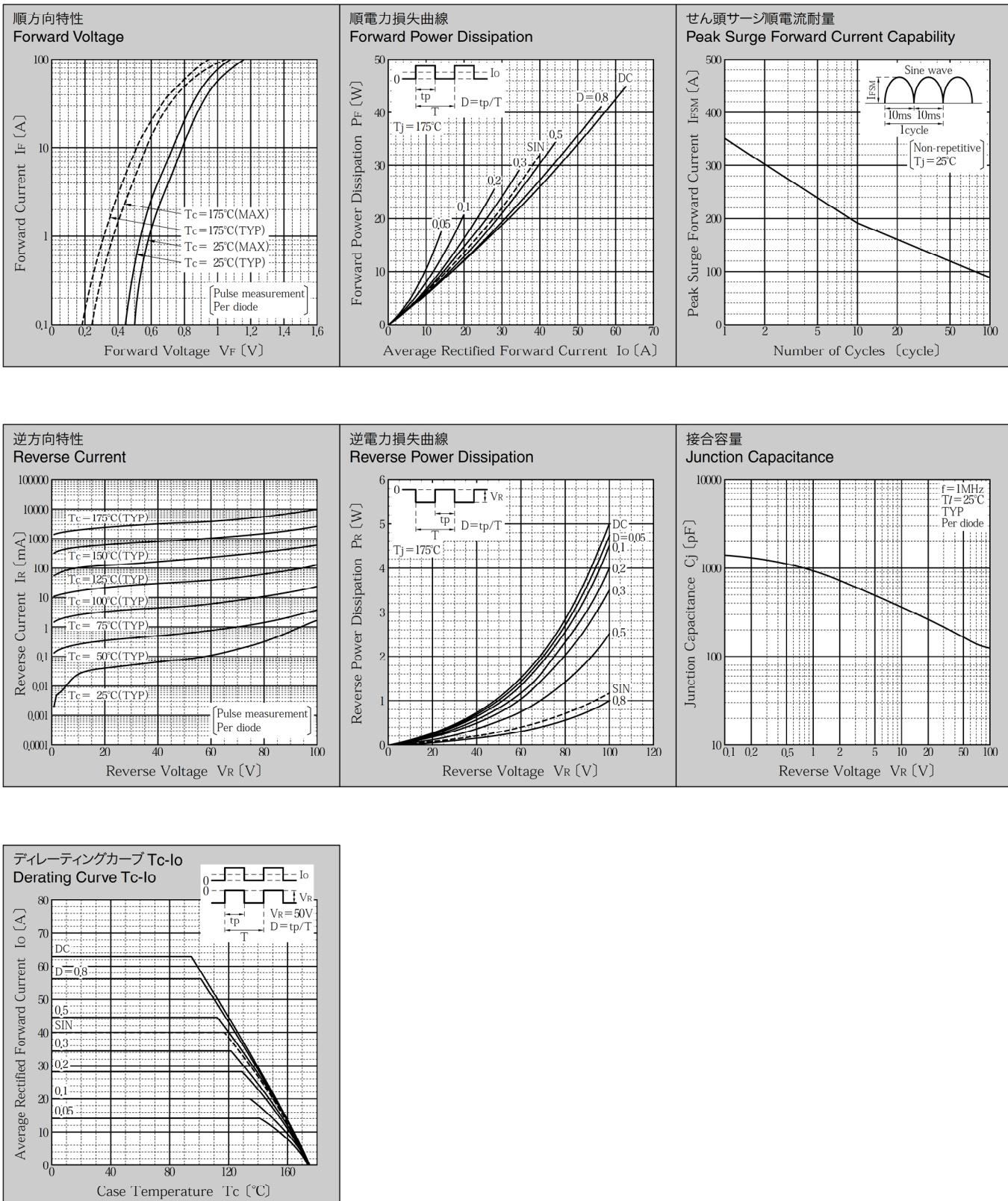
\* Sine wave は 50Hz で測定しています。
