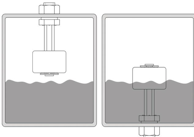
Bei Montage mit aufwärts gerichtetem Steigrohr kehrt sich das Schaltverhalten um.
