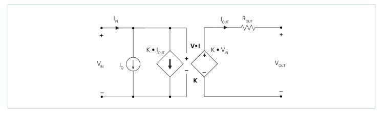
Figure 18 — VI Chip<sup>®</sup> module DC model
